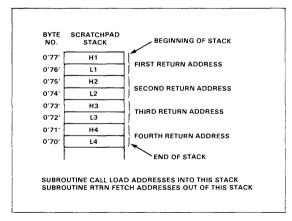
Fig. 7-3. Scratchpad Stack
