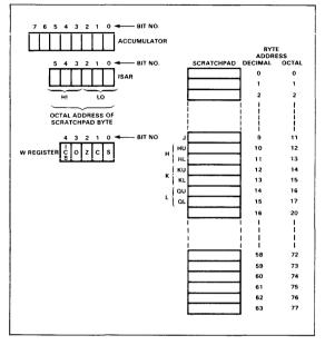
Fig. 2-8. 3850 CPU Programmable Registers
