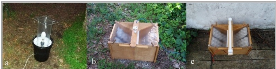
Figura 2. Tipos de luminaria utilizada en las trampas a) vapor de mercurio; b) led ultravioleta; c) fluorescente actínico.
